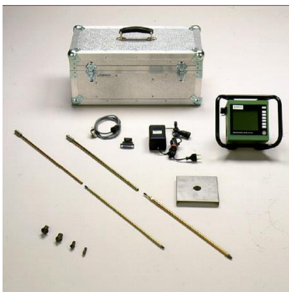
Slika 6.68 Digitalni konusni penetrometar Eijkelkamp Penetrologger
