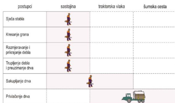
Slika 3.1 Djelomično mehanizirani sustav pridobivanja oblog drva sortimentnom metodom – Prikaz korištenjem modela matrice (Löffler 1989)
