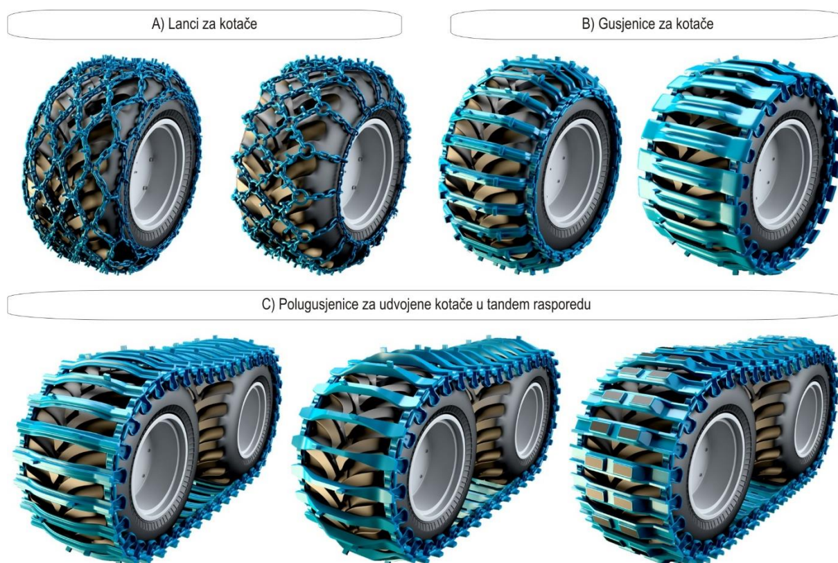
Slika 2.58 Dodatno opremanje šumskih vozila
